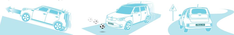
Model Soul EV vás nielenže udrží v pohybe s čo najväčšou úsporou energie, ale vďaka svojej starostlivej stránke vám poskytne aj komplexnú ochranu. Akumulátor, elektrický motor, prevodovka a elektrická riadiaca jednotka sú namontované v čo najnižšom bode pre maximálnu stabilitu. Taktiež tvoria súčasť pevnej konštrukcie karosérie, ktorá chráni kabínu.
